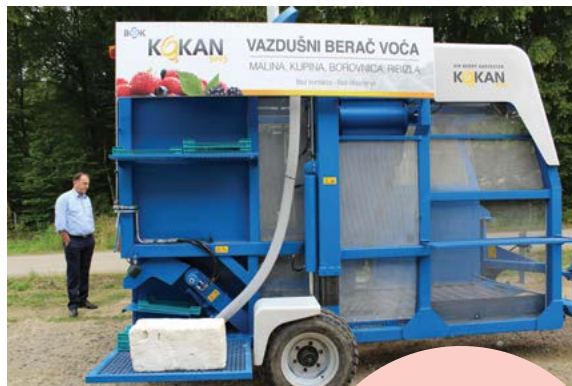
Sl. 11: Mehanizovana berba maline vučenim beračem
